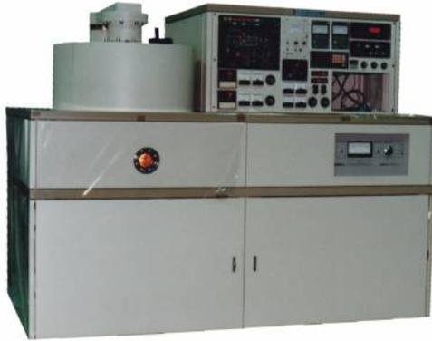
RFスパッタ装置SP-31000Rは成膜室が大きく、小物基材への成膜を目的とした中量産用装置です。基板取付台は公転と自転が個別に動作でき、任意のターゲット上で自転だけの操作も可能です。ターゲットに対する基板の傾き角も変えることが可能で、強い異方性スパッタリングが出来ます。
