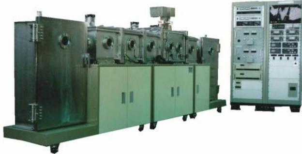
インライン式スパッタ装置SP-2500Rは長尺の帯状、紐状基材に成膜するための装置です。基材の巻出し室(ロード室)の後及び巻取り室(アンロード室)の前に、各々バッファ室が設けられ、バッファ室の間にエッチング室、冷却室、スパッタリング室が配置されています。有機基材への成膜も出来ます。
