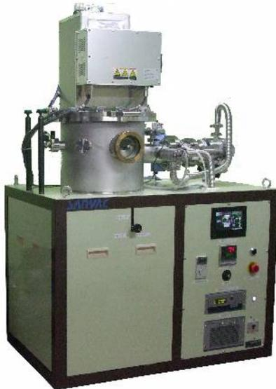
本装置は小型研究開発用のスパッタリング装置と小型装置でありながら3インチ用カソードを3源搭載しております。電源は500Wの高周波電源を1台搭載しており、金属・酸化物・絶縁物等の成膜が可能となっております。
