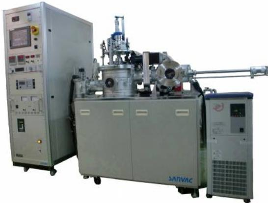
マルチスパッタSP-3300Mは3源スパッタ装置で、各カソードにおいてRFとDC2つのソースを使用することが出来ます。またRFとDCの同時スパッタ成膜も可能です。基板ヒーターはマイクロセラミックヒーターを採用しておりますので、300℃迄短時間で昇温します。大きなオペレートタッチ画面と、初心者でも簡単に操作可能な排気系の自動操作、誤動作防止のための安全回路を搭載。ドライポンプ+ターボ分子ポンプによるクリーンな排気において、金属膜、酸化膜、絶縁膜の良質な成膜が可能です。
