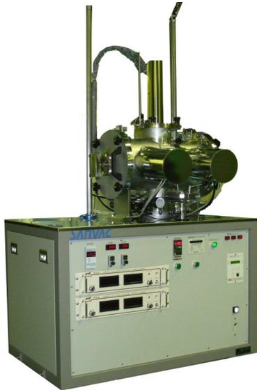
本装置は、対向陰極型マグネトロンスパッタ装置で、2対の陰極を設置し、基板回転によって2種類の薄膜を交互に成膜が可能です。
