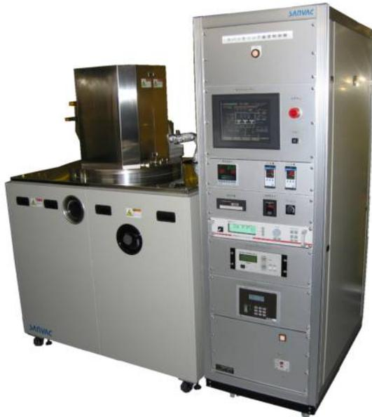
RFスパッタ装置SP-3600は4インチ3源スパッタ装置で、膜厚分布を良くするために各カソードのマグネットが回転する構造になっております。
