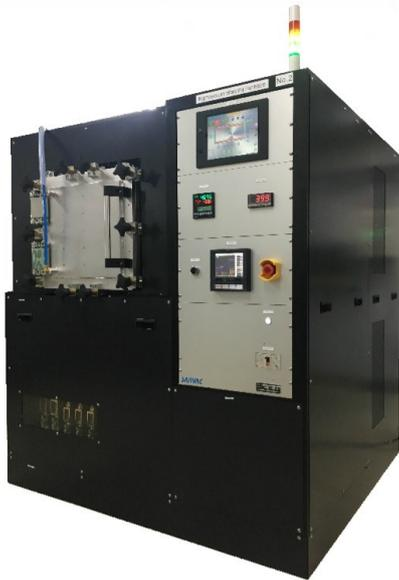
内熱式真空加圧ロウ付け炉D043は、Moヒーターにより均熱領域を最高1000℃まで昇温し、ロウ付けによるガス封止を行う装置です。圧力は $\times 10^{-4}$ Paの減圧領域から266kPaの加圧領域の範囲内にて作業可能です。真空排気、加熱、ガス導入、冷却動作を自動で行います。
