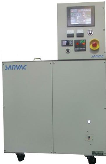
本装置は、高温・真空雰囲気下で小型試片の熱処理を目的とした装置です。
