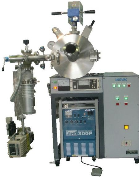
真空アーク溶解炉は消耗電極方式と非消耗電極方式と2種類あります。電源は300Aと600Aを選択可能で、鑄型の形状はご要望に応じてカスタマイズ可能です。弊社独自の急冷構造により、溶解した材料はすぐに取り出し可能です。標準装備として、水冷電極、鑄型、試料反転機構、内部照明灯、油回転ポンプ、油拡散ポンプ、ブルドン管真空計、ピラニ真空計、電離真空計、真空バルブ、ガス導入弁、安全弁、アーク電源から構成され、スタンダード品でご希望の溶解が出来るようになっております。オプションで、排気系自動操作やタッチパネル操作も可能です。
