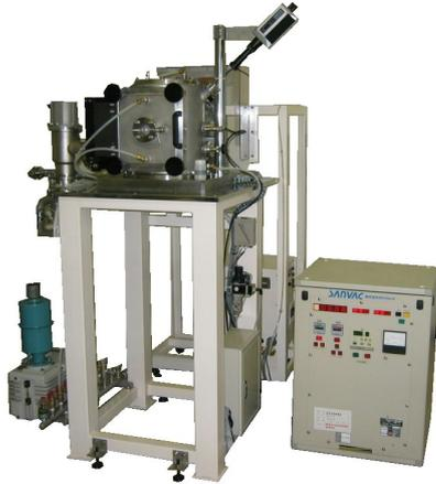
本装置は、高周波電源を使用した高周波誘導加熱真空溶解炉で、主にチタンを溶解する為に開発された装置です。
