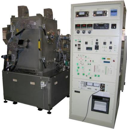
本装置は高真空状態において基材にセラミックをコーティングする装置であり、チャンバー内温度を1200℃近くまで昇温可能です。また本装置の最大の特徴として、基材駆動機構を備えており、基材を回転・旋回・水平進をすることが可能です。蒸発源として電子銃(JEOL製16kW電子銃)を採用しており、インゴット状の蒸発材料に対応する為にルツボ部が昇降・回転制御可能となっております。成膜制御として、シャッター機構を有しておりますが、開閉時間の設定や反復運動の回数設定も行えます。
