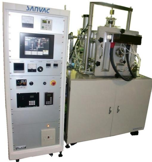
本装置は、メタル・セラミックス型X線管及び電子管を真空中で“ロウ付け溶接”することを目的とした装置です。
