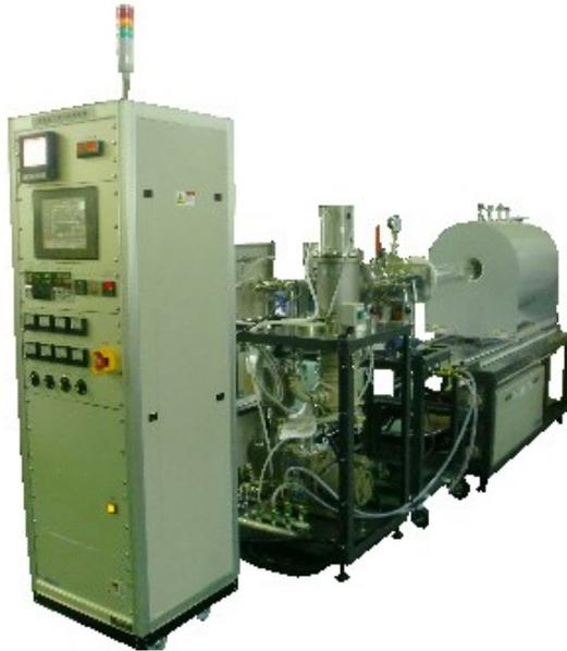
本装置は、電極とアルミナ管を銀ロウ付けし、一定圧にてガスを封入するための装置です。
