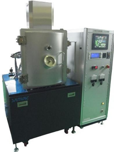
高真空蒸着装置RD-1500は金属を成膜するための蒸着装置です。
