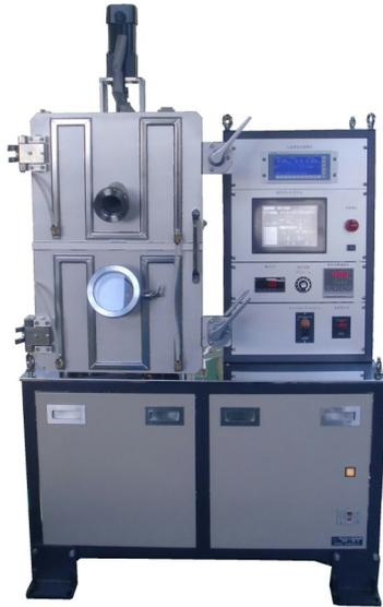
高真空蒸着装置RD-1400は小型蒸着装置の水晶振動式膜厚計搭載型抵抗加熱蒸着装置です。
