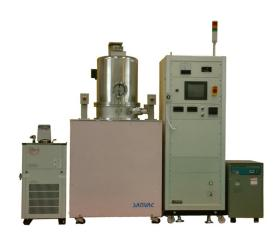
高真空蒸着装置 RD-1300 は、Au、AuZnNi、 AuGeNiをウェハ基板に成膜する為の装置です。 メイン排気系はクライオポンプを採用し、蒸発源 は抵抗加熱により構成されています。抵抗加熱機 構はボリュームによる手動操作またはプログラム コントローラによる自動操作を切替スイッチにて切 替えることが可能です。基板冷却機構も付加され ております。
