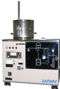
高真空蒸着装置RD-1250Rは高校・専門学校・大学の真空工学教育用に開発された装置です。抵抗加熱機構を2対装備しており、サイリスタ制御により蒸着電圧及び、電流値の調整が可能です。真空工学の授業用として開発された本装置は油回転ポンプ、油拡散ポンプ、ガイスラー真空計等専門書で紹介されている機器を標準装備しておりますので、実体験にて学習が可能です。貴学のご要望に合わせて設計・製作可能ですので是非御相談ください。
