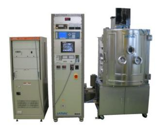
高真空蒸着装置ED-1700は電子銃(JEOL製EBG-102UB4S)による金属・有機物・誘導体を成膜する装置で、ルツボ4点をトリプルソースコントローラにて成膜することが出来る装置です。また基板傾斜機能、膜厚センサーを設けており、排気系はクライオポンプを取付け、短時間にて排気が可能です。オイルフリーを目的としたドライポンプ+クライオポンプ、ターボ分子ポンプの組合せによるクリーンな排気も可能となっています。
