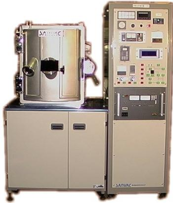
高真空蒸着装置ED-1600は抵抗加熱と電子銃を標準装備しております。金属、貴金属、酸化物の成膜も容易にできます。排気系の立ち上げ、立ち下げ、蒸着準備、ベントを自動で行い、成膜制御も水晶式膜厚計により自動で行います。加熱機構はハロゲンランプ2基を標準装備しておりますので、基板加熱も300℃まで短時間で昇温可能です。研究用として開発された本装置は中規模の生産用としても十分満足できる仕様で、各方面の研究機構、メーカー様に納入させて頂いております。蒸着装置は金額が高価だという多くのご要望を、弊社は原価の見直しを行った結果、中規模生産用装置として破格の1000万円台を実現しました。仕様も多種多様。貴社・貴学のご要望に合わせて設計・製作可能ですので是非御相談ください。
