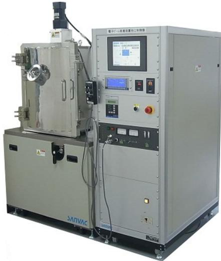
高真空蒸着装置ED-1500は金属・誘導体・半導体等を成膜するための蒸着装置です。電子銃10kWのルツボサイズが40mLと大きく、ルツボ点数も6点ありますので多層膜や数十ミクロンの成膜も可能です。
