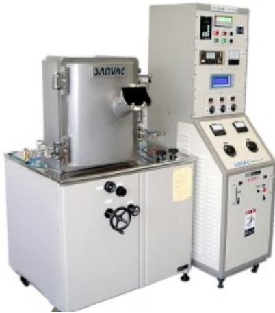
高真空蒸着装置ED-1500Rスタンダード型は抵抗加熱と電子銃を標準装備しております。有機物、金属、貴金属、酸化物の成膜も容易にできます。電子銃のルツボは1mLを3点、抵抗加熱も3点有しておりますので、多層膜の成膜も可能です。また水晶振動式膜厚計を標準装備しておりますので、膜厚監視も可能です。排気系はクリーンポンプとしてターボ分子ポンプを採用しておりますので、オイルミストも気になりません。
