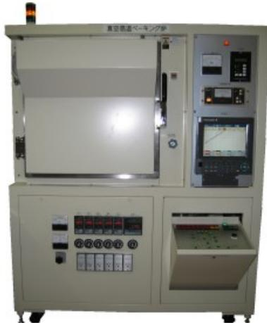
真空脱ガス炉SBF-H500TAは各種部品の真空加熱を目的とした装置です。最高加熱温度は500℃まで昇温可能です。炉体内部は5段式となっており、コンパクトな装置で大容量の脱ガスが可能です。排気系は、ターボ分子ポンプを採用しておりますのでクリーンな排気です。
