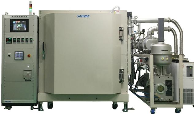
真空乾燥装置E069は、部品を減圧下において加熱し、乾燥処理をおこなうことを目的とした装置です。各ヒーターゾーン6面を独立したPID方式にて制御しておりますので、温度指示値の信頼性も非常に高くなっております。
