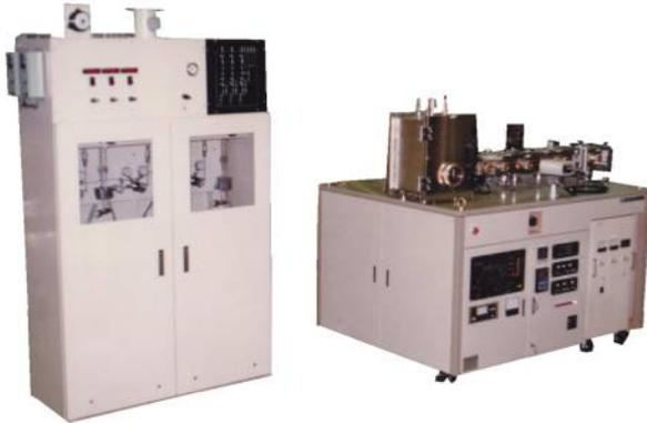
CVI装置CI-4500は糸状のカーボン繊維を1200～1500℃に加熱して、CVD法により、カーボン膜やSiC膜を含浸させることのできる実験用CVI装置です。
