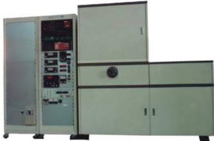
RFスパッタ装置SP-31000Rは5インチから数mmのチップまで、多様な寸法のスパッタリングが可能です。ターゲットを大きくするとともに、良い膜厚分布を得る事の出来る構造になっています。1台のスパッタリング用電源で、3個のターゲットに対して自動切り換え印加が可能です、多層膜生成用に適しています。
