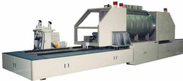
バレル型スパッタ装置SP-163000Dは粉粒体、小片、小球等、基材同士が接触しても問題のない場合の成膜に適しています。回転バレル内に収納(最大収納量20000mL)された基材は、バレル内で混合され、基材の全表面に成膜できます。
