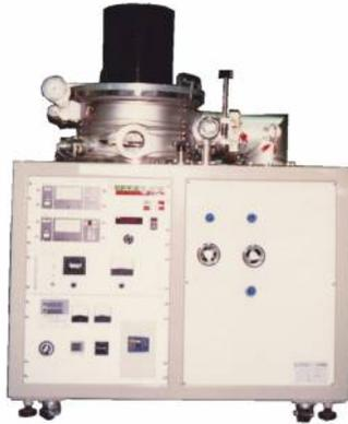
DCスパッタ装置SP-15000Dは実験用の小型装置ですが、大型ターゲットとクライオポンプによるドライ系排気が特徴です。AlやAl-Si膜のように、残留ガス(酸素、水分等)の存在が問題になるようなスパッタリング実験に適しています。設置床面積も小さく、使い易い装置です。
