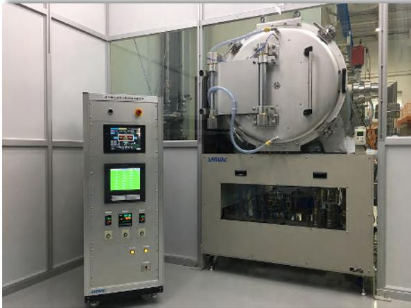
超高真空熱処理炉UHF-1150の加熱源はMoヒーターとリフレクターを採用しており、最高温度1150℃、昇温時間200℃/hrの加熱能力を有しております。真空排気系はドライポンプとクライオポンプによる排気でクリーンな排気が可能です。
