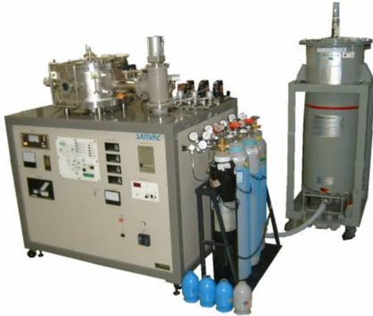
本装置はPoly-Si膜・酸化膜・窒化膜などをCF<sub>4</sub>, CHF<sub>3</sub>, SF<sub>6</sub>等のガスでエッチングするための装置です。
