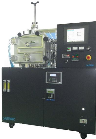
超高真空溶解炉は合金材料における含有水素量の低減を図るため、超高真空下における溶解を行うために使用する抵抗加熱式の電気溶解炉です。
