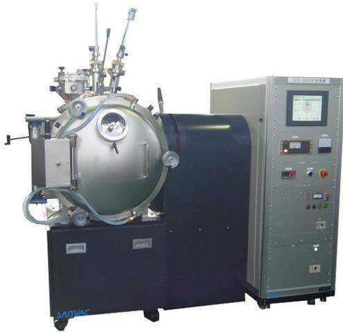
高周波誘導加熱真空溶解炉SVM-1000は誘導加熱式溶解炉で、金属を高周波誘導加熱により溶解する装置であります。
