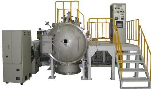
高周波誘導加熱真空溶解炉SVM-30000は金属材料及び合金を最大30kg真空中または不活性ガス雰囲気中にて溶解・鋳造する装置です。50kWの高周波電源を採用しておりますので、短時間に溶解が可能で、生産ライン用として開発された装置です。従来の真空溶解炉は制御盤が大きく、作業スペースが狭いとの声に配慮し、制御盤の省スペース化も実現。排気系は油回転ポンプ+メカニカルブースターポンプ+7500L/secの油拡散ポンプの組合せにより短時間にて排気可能です。
