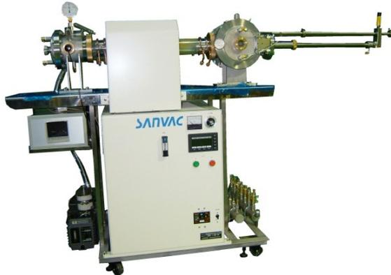
本装置は、ガラス材料を真空中または不活性ガス中で溶解し、磁場中で急冷固化を行う研究目的の装置です。
