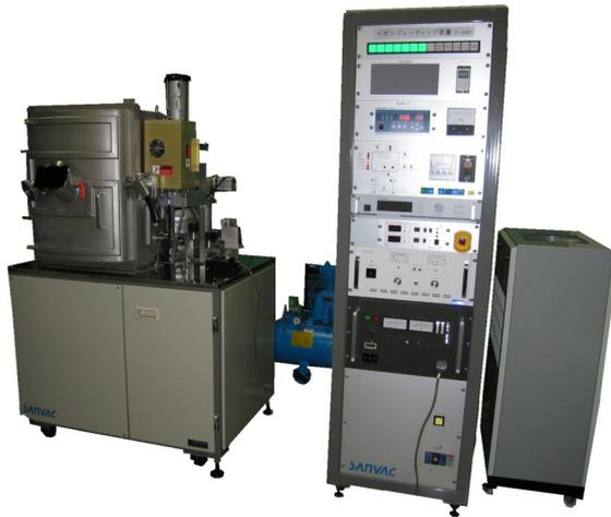
イオンプレーティング装置IC-1500は、油回転ポンプ・油拡散ポンプ・液体窒素トラップの排気系で構成され、粗引開始後5分で $\times 10^{-4}$ Pa台まで到達します。EB方式により、あらゆる誘電体や金属の成膜に対応することが可能です。また直流安定化電源(バイアス用)、加熱機構、水晶式膜厚計も標準搭載しておりますので、より密着性の高い膜&膜厚精度の高い膜を成形することも可能です。
