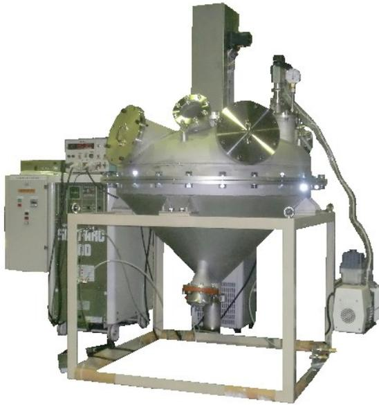
本装置は、高品質金属粉末を製造するための各種の方法の中で、回転電極法(Rotating Electrode Process)、通称レップ式を用いて金属粉末を製造する装置です。
