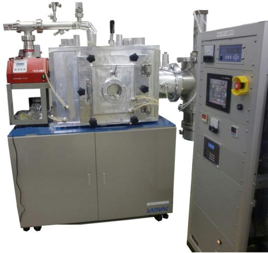
本装置は、電界電子放出型エックス線管(FE型X線管と表す)の製造プロセスにおいて、高性能なFE型X線管を製造するためのエージング処理に使用いたします。
