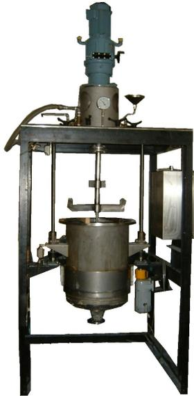
本装置は真空下で粘性のある液体を攪拌することにより、被液体に含有されている空気や水分を除去することが出来る装置です。本体外壁には冷却水ジャケットが付属しており、溶液の冷却に使用できます。加熱機構も標準装備されておりますので、加温も可能です。また圧空導入口が装備されていますので、お手持ちのコンプレッサー等に接続することで、粘性のある液体を別容器に重鎮することが出来ます。貴社・貴学のご要望に合わせて設計・製作することも可能ですので是非御相談ください。
