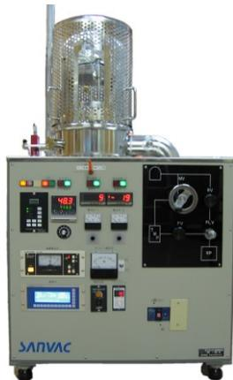
高真空蒸着装置RD-1300Rは小型蒸着装置の水
