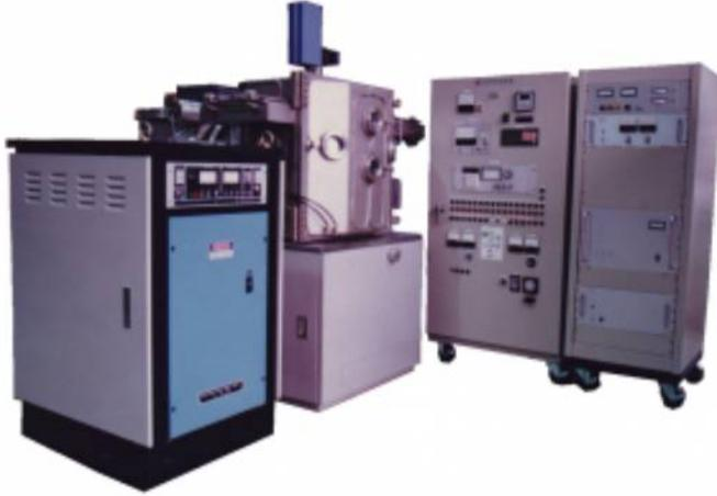
大型真空蒸着装置ED-3100はマスフローコントローラ式ガス導入系をもっているため、反応性蒸着が可能です。光学式と水晶式の2種類の膜厚モニターによって、各種の膜厚制御が可能です。
