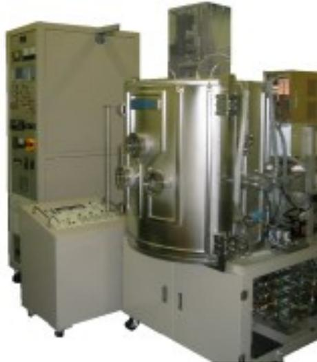
高真空蒸着装置ED-1700は電子銃(JEOL製 JEBG-303UA)によるマルチコートを目的にした装置でありルツボ4点(予備1点)をトリプルソースコントローラにて成膜することが出来ます。また基板急冷機構及び膜厚センサーを4箇所設けてあります。排気系はオイルフリーを目的とし、ドライポンプ+クライオポンプ、差動排気用ターボ分子ポンプの組合せにより短時間かつクリーンな排気が可能です。まさに新時代に必要な万能装置といえるでしょう。
