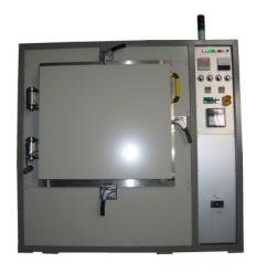
真空脱ガス炉SBF-H300Rは成型部品の真空加熱を目的とした装置です。最高加熱温度は300℃まで短時間で昇温可能です。炉体内部は標準で2段式となっておりますが、ご要望に応じて製作することも出来ます。加熱制御は、上面・左右側面・前後面・下面各々コントローラーで制御可能です。
