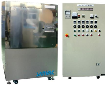
真空脱ガス炉SBF-250は各種部品の真空加熱を目的とした装置です。最高加熱温度は250℃まで昇温可能です。炉体内部は5段式となっており、コンパクトな装置で大容量の脱ガスが可能です。排気系は、ロータリーポンプとメカニカルブースターポンプを採用しておりますので大容量の排気が可能です。操作は排気系の立ち上げ・昇温工程・排気系の立ち下げがスイッチ1つで行え、初心者の方にも簡単にオペレート出来ます。
