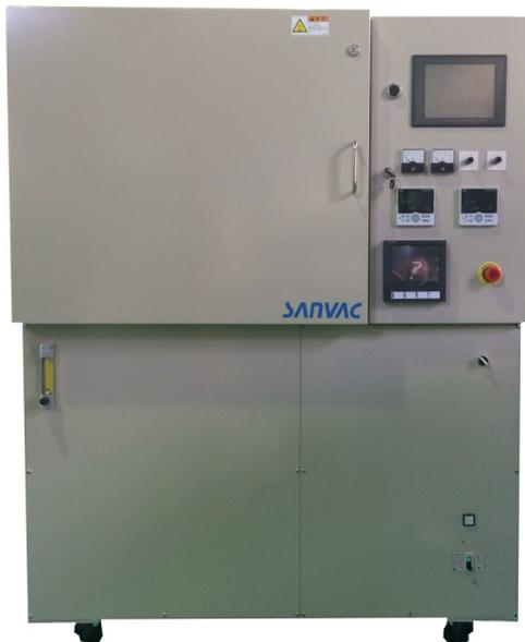
真空脱ガス炉SBF-1100はガラスフリット等を、大気圧雰囲気、不活性ガス雰囲気、真空雰囲気下で熱処理を行う装置です。ガス圧力を自動で制御し、圧力を一定にしたまま作業が可能です。
