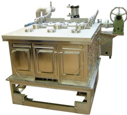
本装置は高真空状態において500℃近くまで昇温し、被固体の脱ガス化を行う為の装置です。本装置の排気系はドライポンプとクライオポンプを採用しており、オイルフリーの環境に対応しております。到達圧力は $\times 10^{-5}$ Pa台ですので、非常にクリーンな環境で脱ガス処理を行うことが可能です。
