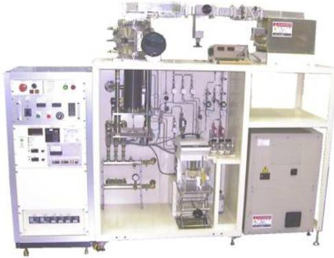
マイクロ波CVD装置SDM-2はマイクロ波CVDによるダイヤモンド薄膜の試験製造装置。シリコンウエハ上に直径10mm程度、厚み10 $\mu$ 以上のダイヤモンド膜を成膜できます。
