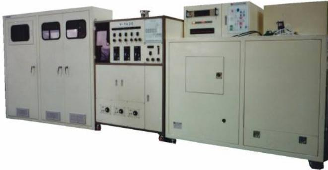
炭化ケイ素(SiC)に代表される超高温材料は、その生成温度と濃度によって様々な結晶構造をとります。サーマルCVD装置CT-6000はこれらの未来材料の研究をするために、制御圧力範囲を6.65～101kPa、制御温度範囲を800～2000℃と幅広く条件を取れるようになっています。
