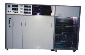
サーマルCVD装置CT-5500はポリSi(第1炉)、SiO、PSG、BSG(第2炉)、Si $_3$ N $_4$ (第3炉)をコーティングできます。各炉は、それぞれ独立したCVD炉なので、異質物の混入がありません。1台で3台分の働きをする小ロット生産用CVDです。
