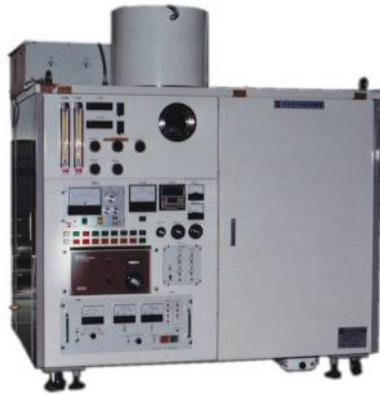
プラズマCVD装置CP-1900はステンレスチャンバー内に置かれた基板に発生したプラズマにより、成膜します。上部電極は、ガスシャワーが装着されており下部の基板ホルダーには、ヒーターが埋め込まれています。またコンパクトに出来ていますので、小さな実験室でも設置することができます。
