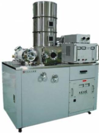
プラズマCVD装置CP-1700は縦型石英管の外周に置かれたコイルによって発生したプラズマ中を、ヒーターを内蔵した基板ホルダーを上下することができます。これによって、ダウンフローによるプラズマCVDの実験もできます。また基板には、DCバイアスをかけることができます。
