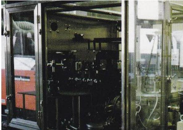
MOCVD装置CM-8000は上部はガスシャワーになっており、RFプラズマを印加する事ができます。また下部は800°Cに加熱しながら回転できる基板ホルダーが取り付けられております。フレキシブルな実験ができるMOCVD装置です。
